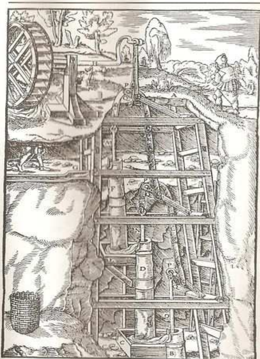
A: Puits B: Premier tuyau C: Premier bassin D: Deuxième tuyau E: Deuxième bassin F: Troisième tuyau G: Rigole d'évacuation H: Pièce de fer fixée dans l'axe I: Première bielle K: Deuxième bielle L: Troisième bielle M: Première tige de piston N: Deuxième tige de piston O: Troisième tige de piston P: Petits axes Q: Gouilles
