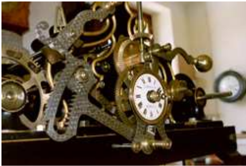
Sonnerie à râteau d'une horloge L.-D. Odobey
