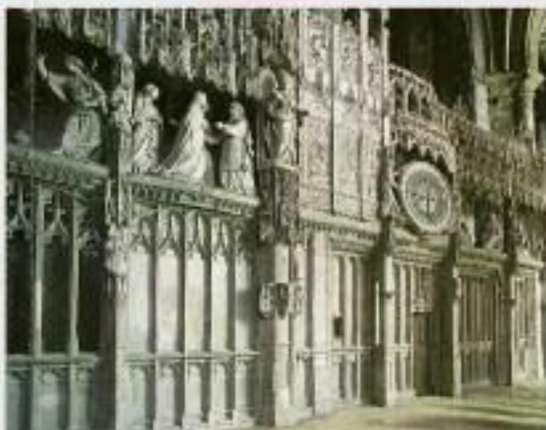
Son cadran d'un mètre environ de diamètre indique les 24 heures de la journée, les phases de la lune, le temps d'un cycle lunaire et les signes du zodiaque correspondants au mois de l'année. L'unique aiguille de l'heure est munie d'une fente longitudinale dans laquelle un petit soleil se déplaçait afin d'indiquer la hauteur de l'astre en fonction des périodes de l'année.
